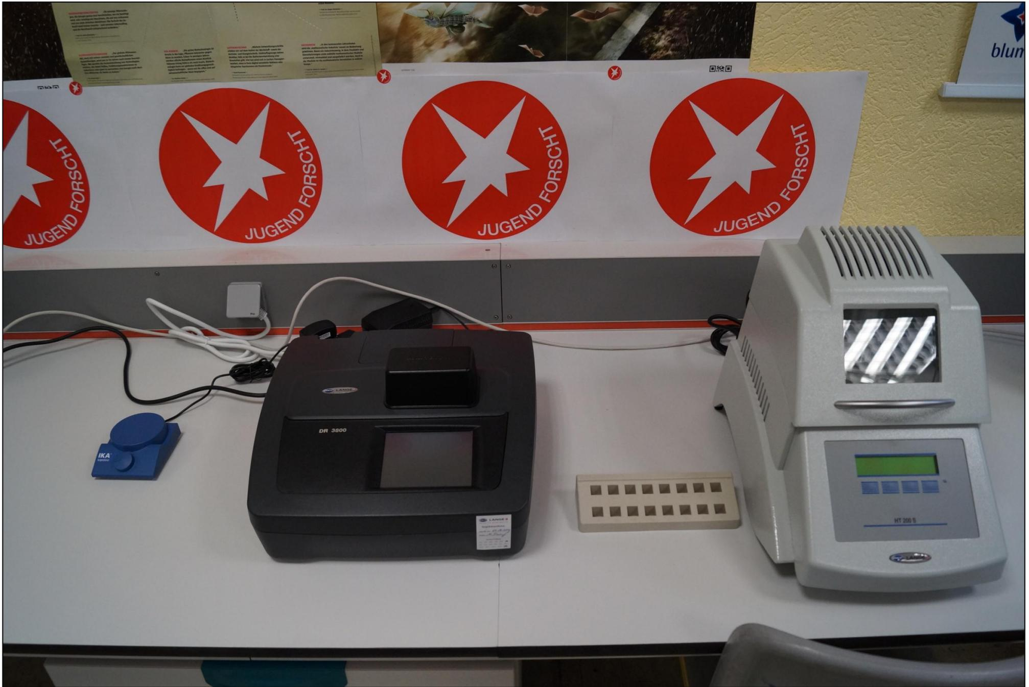
**Magnetrührer, VIS-Spektralphotometer, Küvettenständer, Thermostat**
