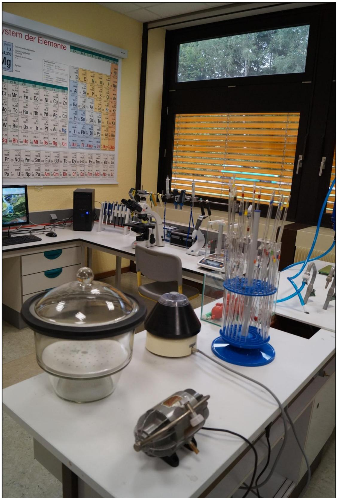
**Exsikkator (vorne links), Kompressor (vorne rechts), Zentrifuge (hinten links), Vollpipetten und Messpipetten inklusive Pipettengestell (hinten rechts)**
