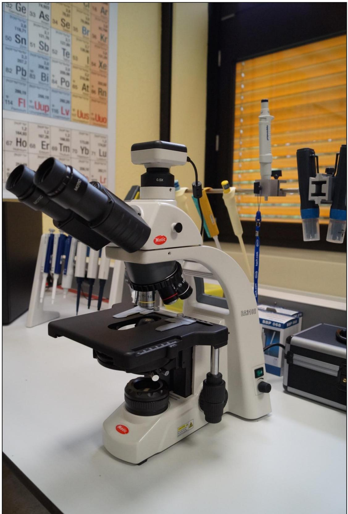
**Forschungsmikroskop inklusive Zubehör (z. B. Mikroskopkamera, Zentrierteleskop Planktonzählkammer), geeignet für Hellfeld-Mikroskopie, Dunkelfeld-Mikroskopie und Phasenkontrast-Mikroskopie**
